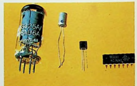
Van radiobuis, via diode en transistor, naar IC.
