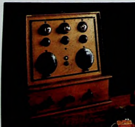
Radio-ontvanger met drie lampen (Telefunken, ± 1930).
