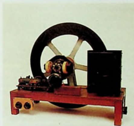
De originele zelfbouw Nipkow schijf van radiopionier J. Corver.
