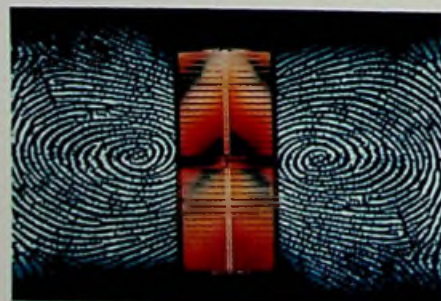
16 Mbit DRAM met meer dan 33.000.000 componenten, 240 duizend per mm 2 (Siemens, 1990).
