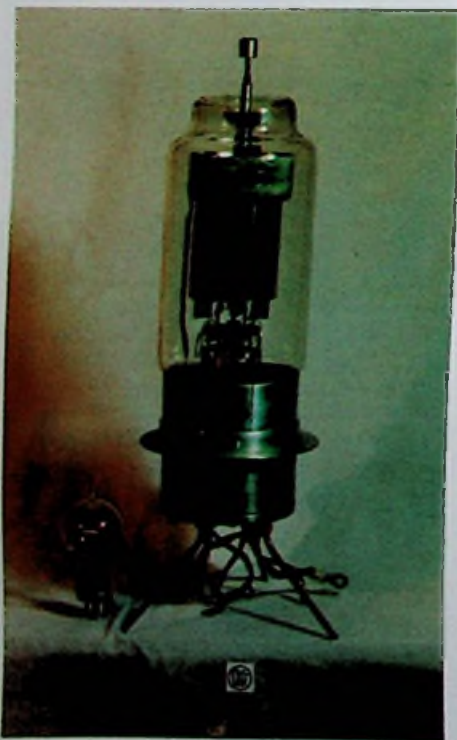
Thyatron voor radar, en triode (1940).
