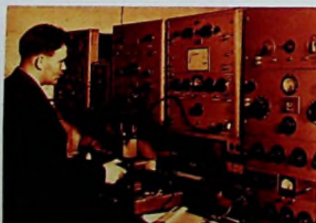
Bill Hewlett test de eerste HP signaal generator, t.b.v. het ontwikkelen en testen van radio- en radarzenders en -ontvangers (± 1940).
