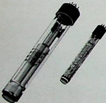
Mini-plumbicon en plumbicon (1957).
