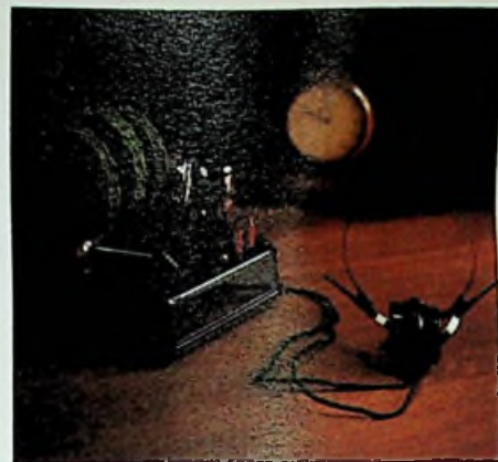
Radiotoestel met lampen en honingraatspoelen (Telefunken, ± 1930).
