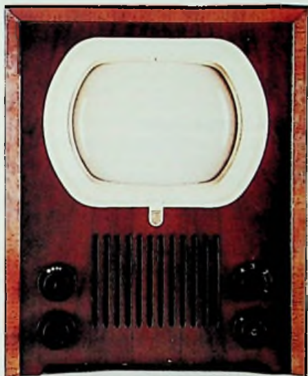
Het eerste door Philips in verkoop gebrachte TV-toestel, met 22 cm beeldbuis en 4-kanalenkiezer, bijnaam 'hondehok' (1950).
