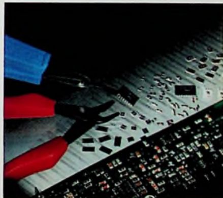
SMD zorgt voor een vergaande miniaturisering in printmontage.
