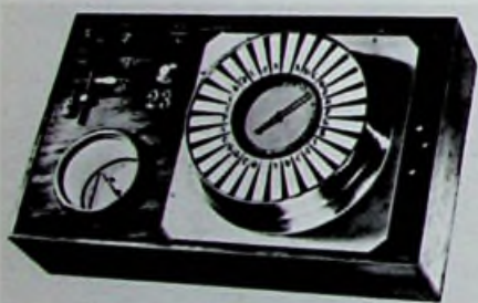
'Wijzertelegraaf' van W. Siemens (1848).
